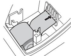
3. (Für das Drucken auf dem Journalstreifen) Obere Kante des Papiers in den Schlitz an der Welle der Aufwickelspule einführen und Papier zwei- bis dreimal um die Welle wickeln.
