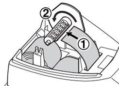
4. (Für das Drucken auf dem Journalstreifen) Aufwickelspule auf die Halterung auflegen.
