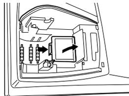
3. Die drei neuen R6- oder LR6-Batterien (Größe AA) einsetzen. Sicherstellen, daß die Batterien richtig eingesetzt werden (siehe nachfolgende Abbildung).
