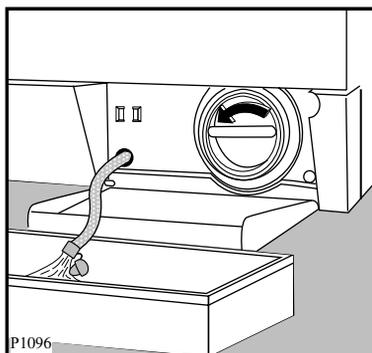
4. Wenn das Wasser vollständig abgelassen ist, den Deckel der Ablaufpumpe entgegen dem Uhrzeigersinn abschrauben und herausziehen.
