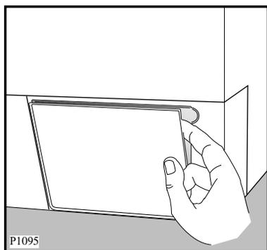
3. Notentleerungsschlauch aus seinem Sitz herausnehmen, Auffanggefäß unterstellen und Verschlussstopfen des Schlauchs herausziehen.
