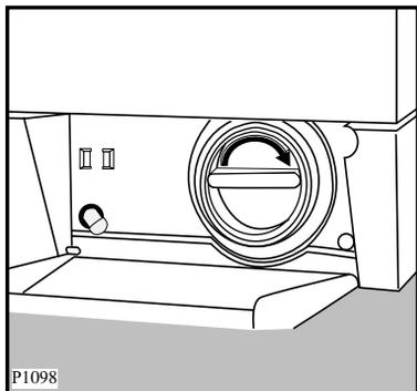
7. Die Grobkörperperle einsetzen und den Deckel im Uhrzeigersinn wieder fest verschrauben.
