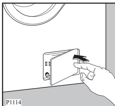
3. Notentleerungsschlauch aus seinem Sitz herausnehmen, Auffanggefäß unterstellen und Verschlussstopfen des Schlauchs herausziehen.
