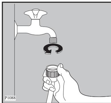
Bei geöffnetem Wasserhahn (unter vollem Leitungsdruck) die Anschlussstelle am Gerät und am Wasserhahn auf Dichtheit prüfen!
