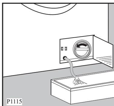
4. Wenn das Wasser vollständig abgelaufen ist, den Deckel der Ablaufpumpe entgegen dem Uhrzeigersinn abschrauben und herausziehen.
